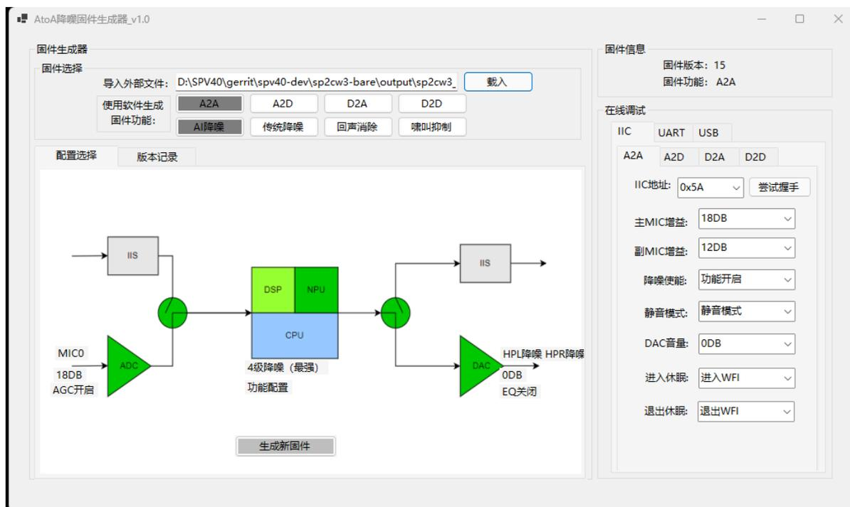
2.点击【MIC0】或者【18DB】，弹出新窗口，可以配置ADC的增益，更改完成后关闭该窗口，如下图：
